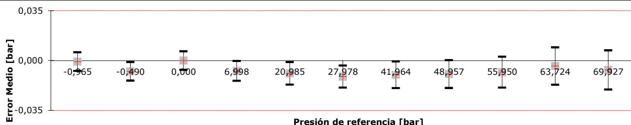
Las líneas horizontales rojas del gráfico corresponden al EMT del instrumento calibrado.
